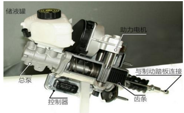
图 10：智能汽车刹车系统（ABS）
