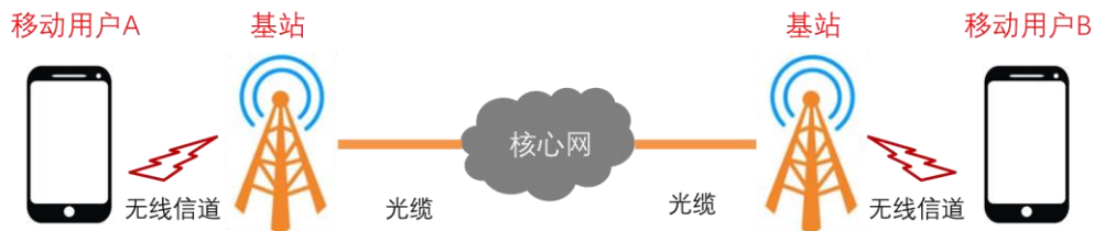
图 1：无线通信过程示意图
