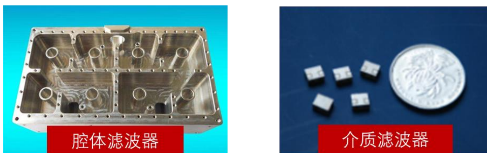
图 28：腔体滤波器和介质滤波器实物图
