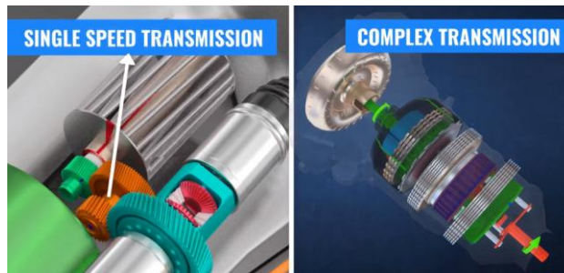
图 14：新能源汽车采用单级减速装置
