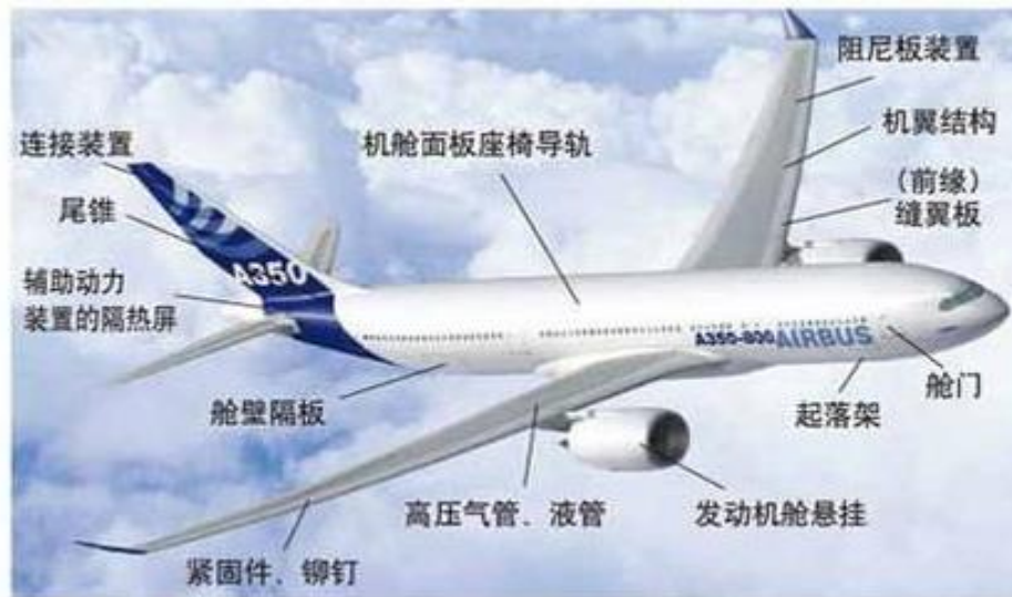
图1：钛合金在飞机上主要应用部位和部件
