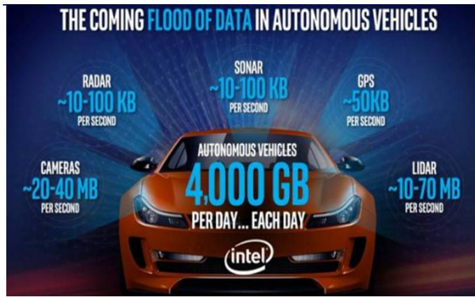
图 40：自动驾驶汽车各传感器所产生的数据量
