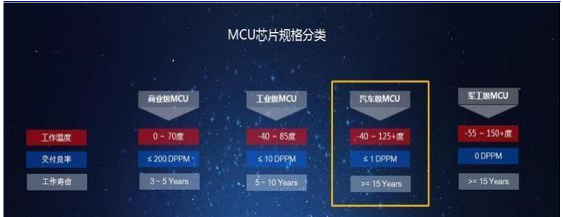
图 70: MCU 芯片规格分类, 汽车级 MCU 要求极高
