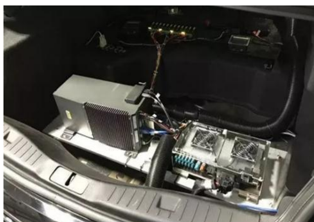
图 39：2018 年 CES 百度自动驾驶汽车后备箱配备的计算平台（工控机+英伟达 drivepx2）
