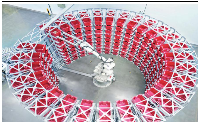
图16： ABB 机器人轻型堆垛机系统
