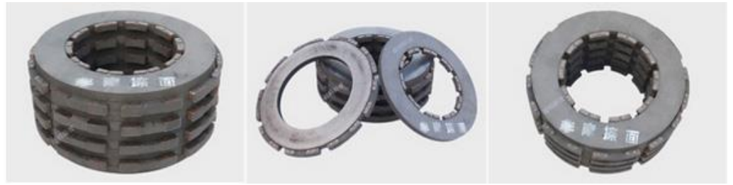
图表40: 西安超码研制的 A320 系列飞机炭刹车盘
