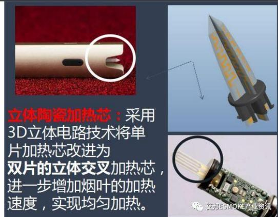
立体陶瓷加热芯: 采用 3D 立体电路技术将单片加热芯改进为双片的立体交叉加热芯, 进一步增加烟叶的加热速度, 实现均匀加热。
