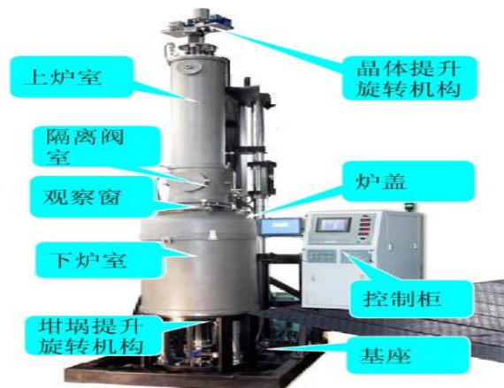
图 17：单晶生长炉设备构成
