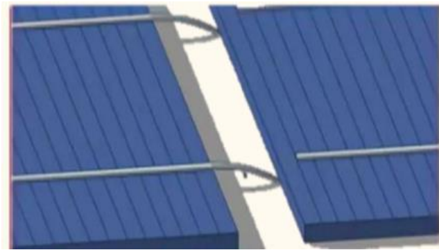
图 61: 互联条工作示意图
