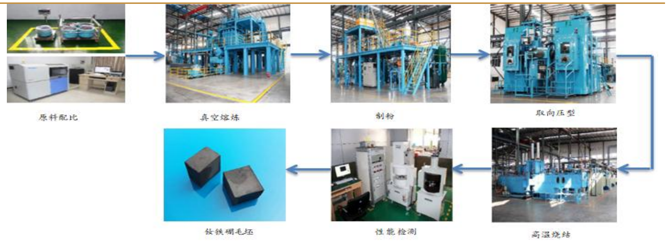
图 6：大型钕铁硼工厂胚料工序示意图
