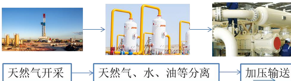
图 1：天然气开采后一般经过油气水分离、加压后输送到下游用户
