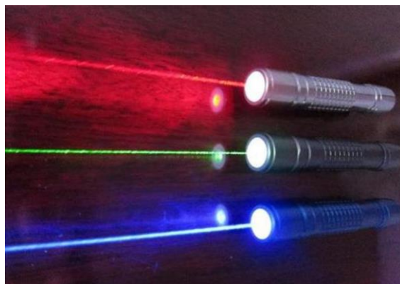
图表 50: 半导体激光器结构简单，体积更小
