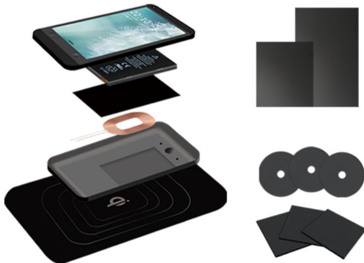
图 5：软磁材料在手机无线充电上的应用
