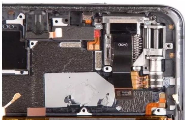
图 11: vivo NEX 隐藏摄像头结构占据了较大空间
