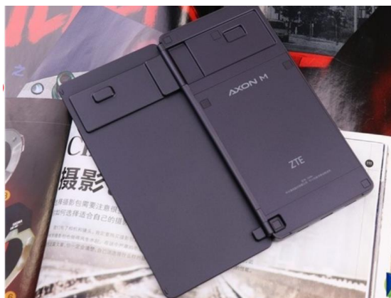
图 32: 中兴 AXON M 折叠屏手机转轴设计
