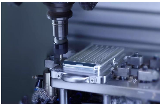
图 21：CNC 加工手机金属外壳
