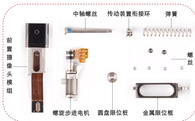
图 12: vivo NEX 升降前置摄像头内部零组件拆分
