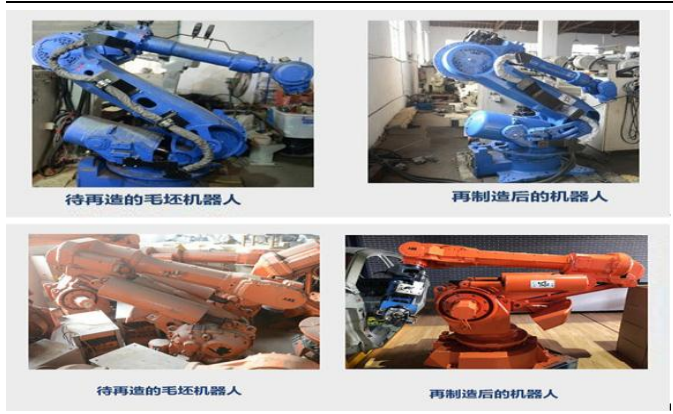
图16: 二手机器人再造前后外观对比
