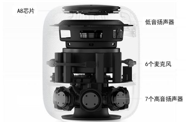
图 19：苹果 HomePod 内部构造
