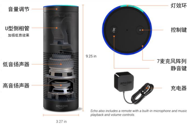
图 18：亚马逊 Echo 内部构造
