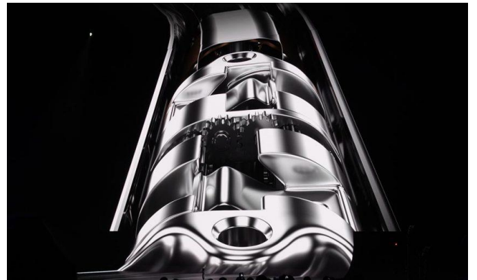
图 3: Galaxy Fold折叠转轴中内含齿轮结构
