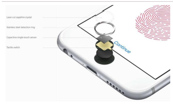
图表63： 电容式指纹识别示意图
