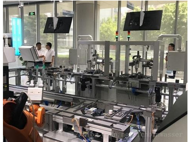
图 26：西门子数字工厂柔性流水线
