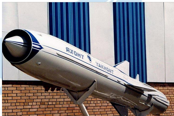
图 27：采用液体冲压发动机的“宝石”导弹
