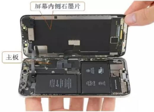
图14: iPhone X的屏幕散热方案
