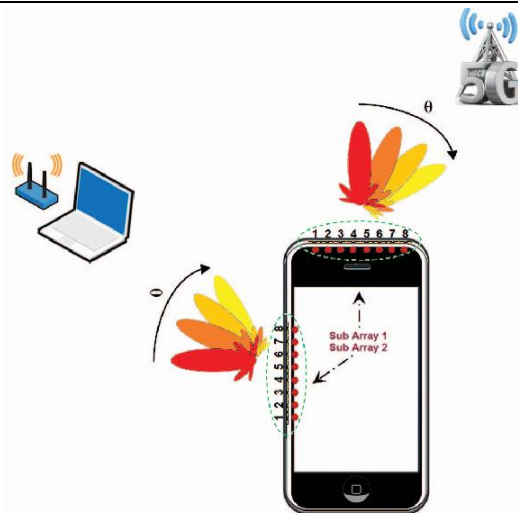
图表 44. 5G 手机中的多用户 MIMO 技术
