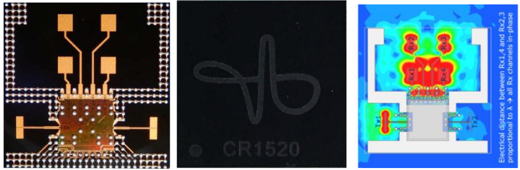
图表 55. Project Soli 芯片 eWLB 封装以及电磁仿真设置
