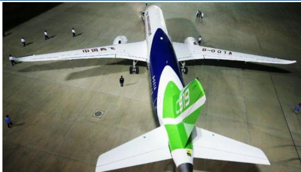
图 9：C919 尾翼主盒段和后机身前段使用了先进的第三代中模高强碳纤维复合材料
