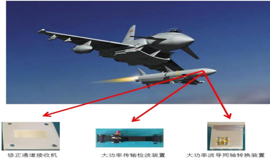
图 29：弹载雷达微波射频前端核心组件
