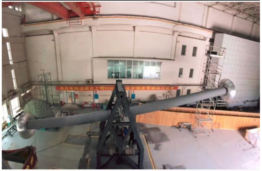
图42: 直流穿墙管套（保护系统）示意图
