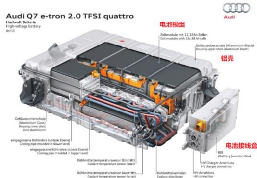
图表15：动力电池包结构图（奥迪 e-tron）
