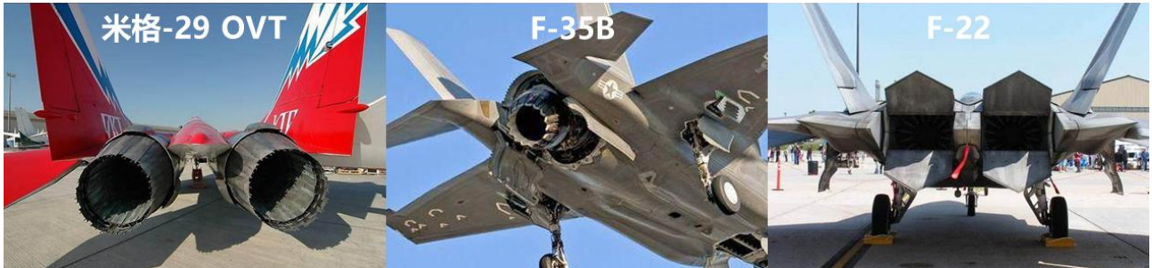
图表 6 航空发动机矢量喷口
