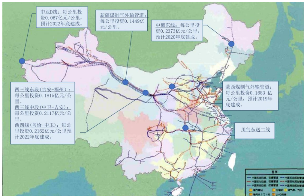
图 11：在建的重要天然气长输管道
