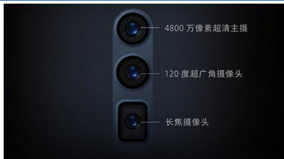
图表 19: OPPO 10 倍无损变焦技术的三摄设计
