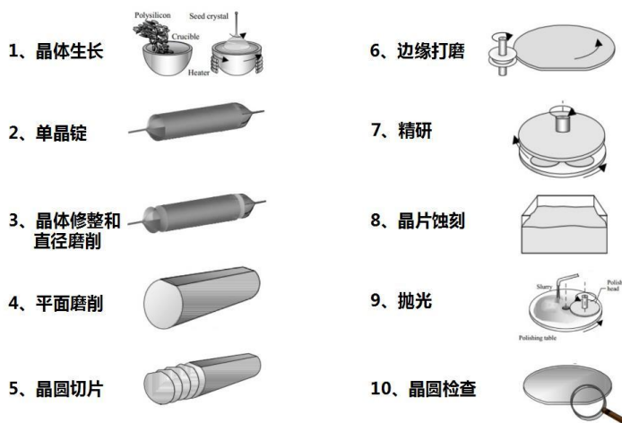
图表 14：硅片制造流程
