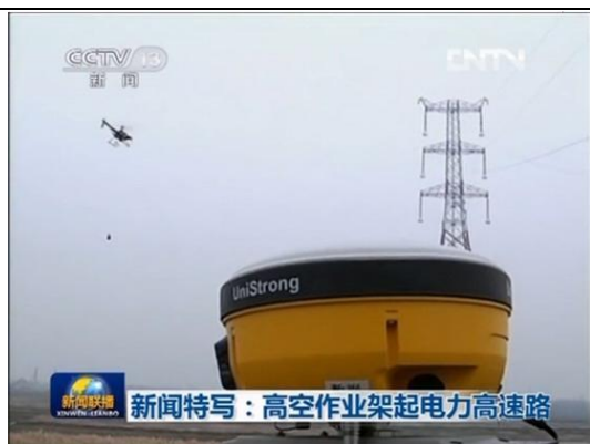
图 6：高精度测量 RTK 助“皖电东送”跨淮河
