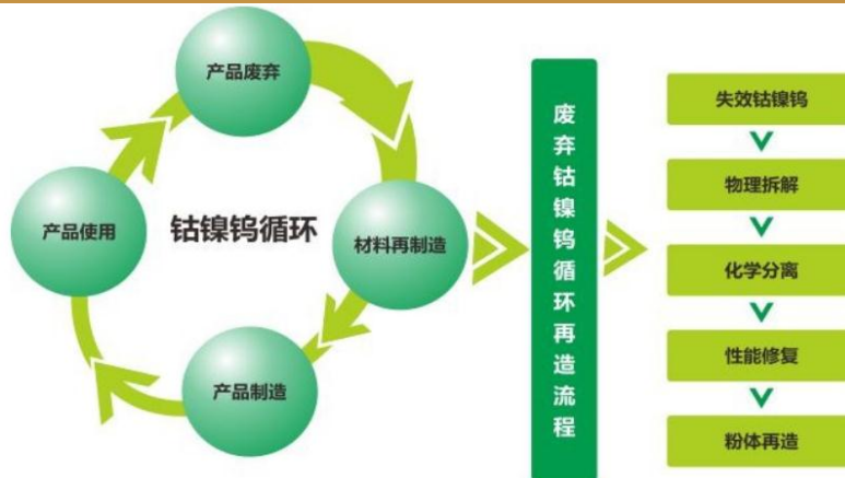
图 14: 钴镍钨稀有金属废料处理工艺流程
