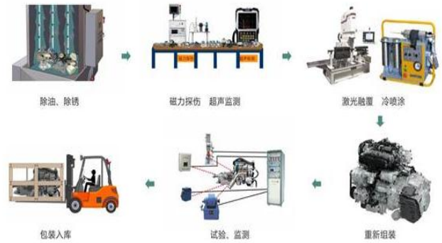
图 23: 公司汽车零部件再造流程图
