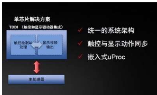
图32: TDDI 集成触控与显示芯片
