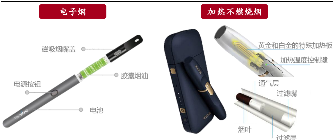
图表33.电子烟、加热不燃烧烟内部结构图
