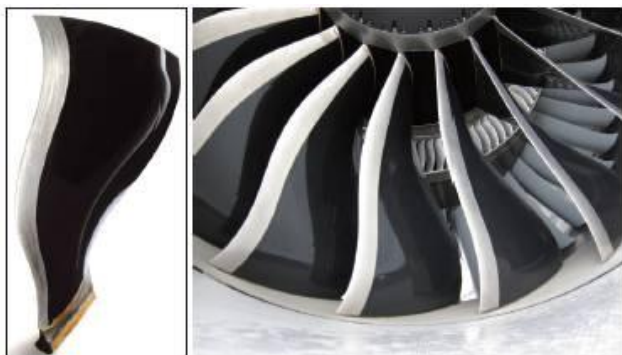
图 38: GE90 涡扇发动机树脂基复合材料风扇叶片
