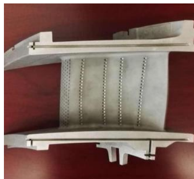
图 41：涡轮叶片表面喷覆陶瓷涂层
