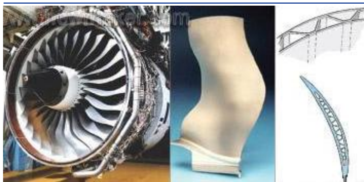
图 39: R&R RB211 涡扇发动机钛合金空心叶片
