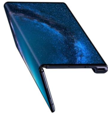
图 11: 华为Mate X采用外折式产品形态设计
