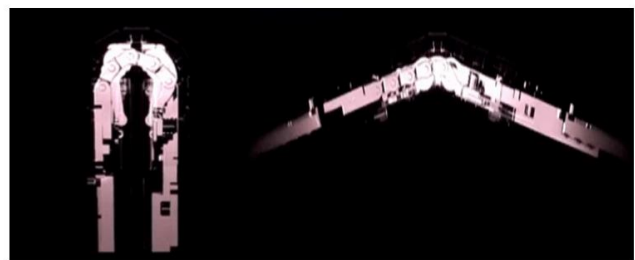
图表32：华为Mate X 鹰翼式铰链结构
