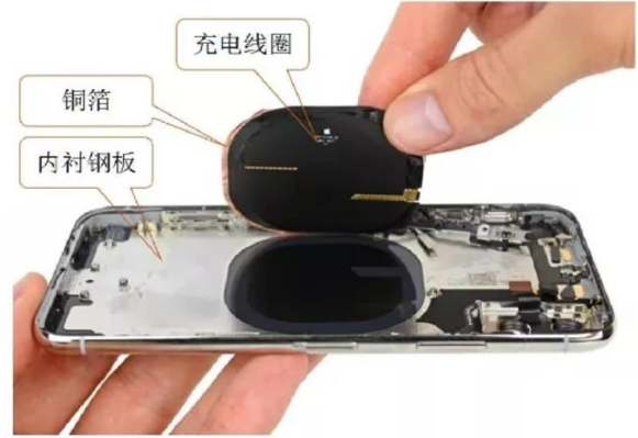
图 48: iPhone X在线圈上贴上铜箔石墨层
