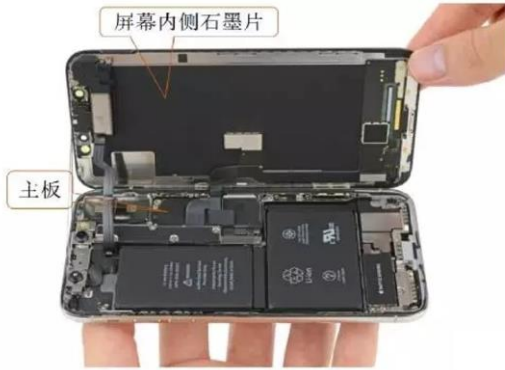
图 47: iPhone X的屏幕散热方案
