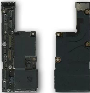
图 38: iPhone XR/XS双层主板表面的散热石墨片
