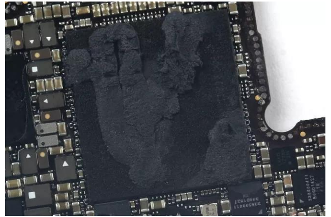
图 39: 苹果A12芯片涂上了大量的导热硅脂散热
