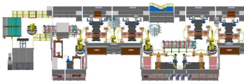
图 39：汽车底盘零部件柔性自动化焊接生产线
