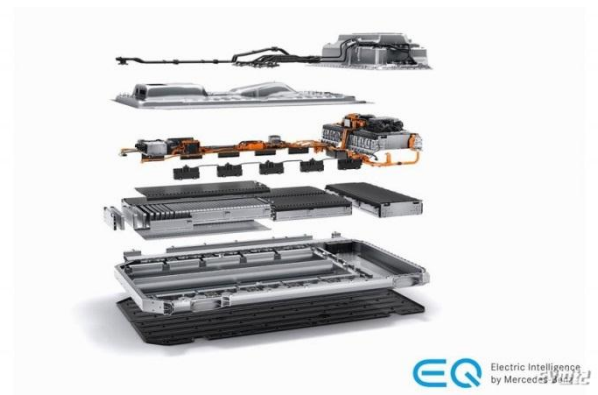
图表37 海外 EQC 采用 LG 软包电池封装
