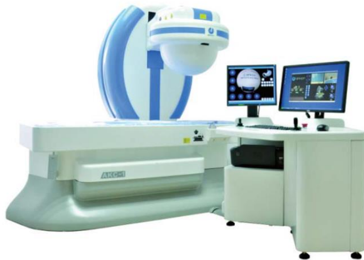
图 4: 巡航胶囊内窥镜控制设备
