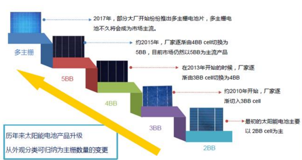
图表 33: 太阳能电池栅线结构的演进趋势是增加主栅数量
