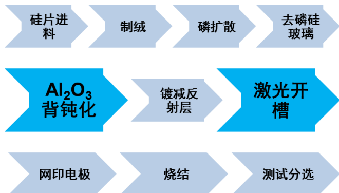
图 48：PERC 相比传统工艺需要额外两步步骤
