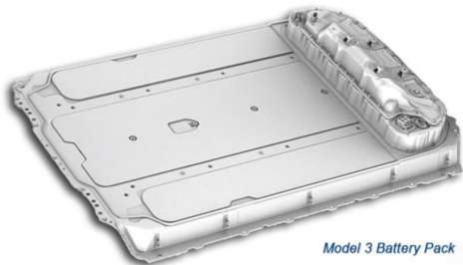
图 8: Tesla Model 3 电池系统（铝制电池壳）
