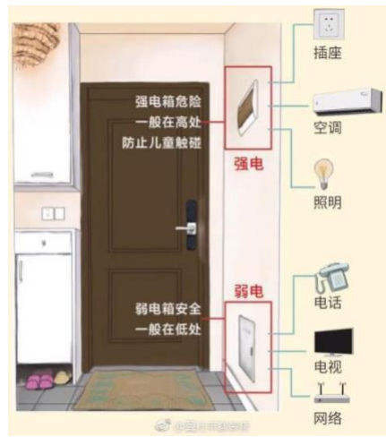
图表 5: 强弱电箱示意图
