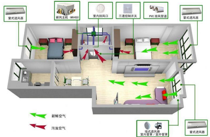
图表 45：新风系统示意图
