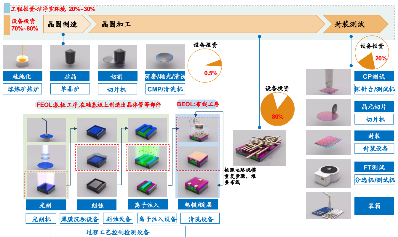
图5: 半导体制造工艺与设备的对应关系
