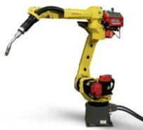
由机器人本体、焊接电源、焊接装备（送丝机、焊枪）等部分组成，主要用于完成弧焊、点焊、激光焊接、激光切割等工作
