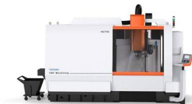
集铣削、镗削、钻削、攻螺纹和切削螺纹等功能于一体，适用于形状较复杂，精度要求高的单件加工或中小批量多品种生产
