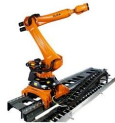
装配机器人是柔性自动化装配系统的核心设备，主要用于电器制造、汽车及其部件、计算机、机电产品及其组件的装配等方面
