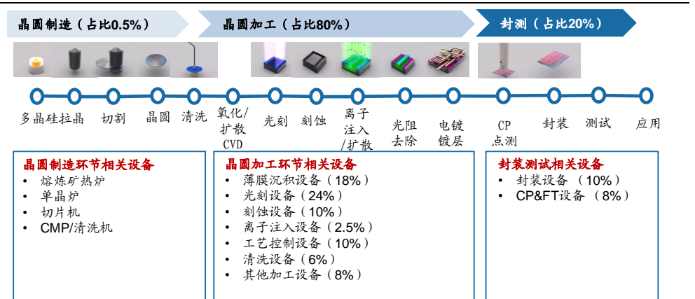
图8：晶圆制造-加工-封测流程及设备需求
