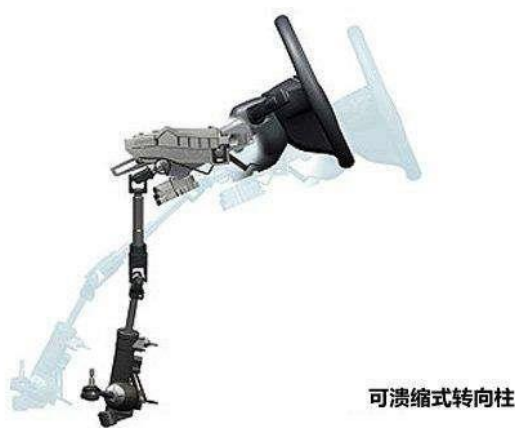
图 12：汽车被动安全配置——溃缩式转向柱
