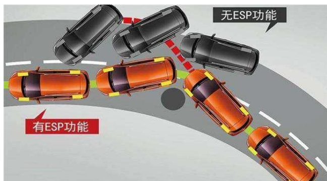
图 9：汽车主动安全配置——车身稳定系统作用示意图
