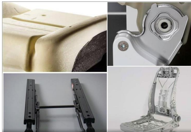
图8：汽车座椅主要结构拆解
