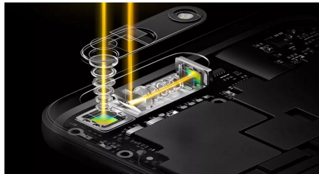
图 4: 广角+潜望式长焦摄像头模组
