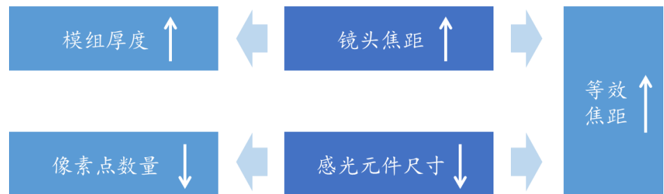
图 2：智能手机摄像头等效焦距拉长的掣肘因素
