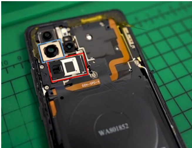
图 5: 潜望式模组 (红) 和普通模组 (蓝) 面积对比
