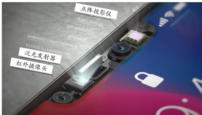
图 18: iPhone X 3D Sensing 结构示意图
