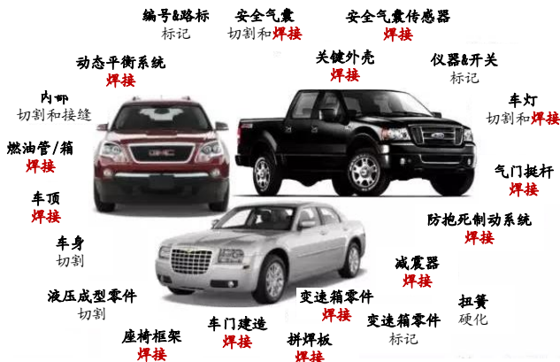
图11: 激光焊接在汽车中的应用一览
